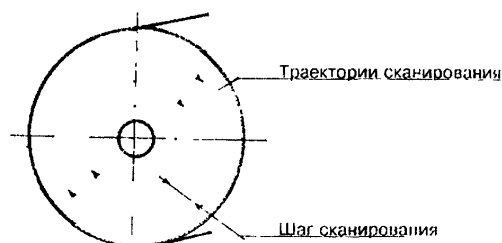
Рисунок К.3 - Траектории сканирования торцевой поверхности
