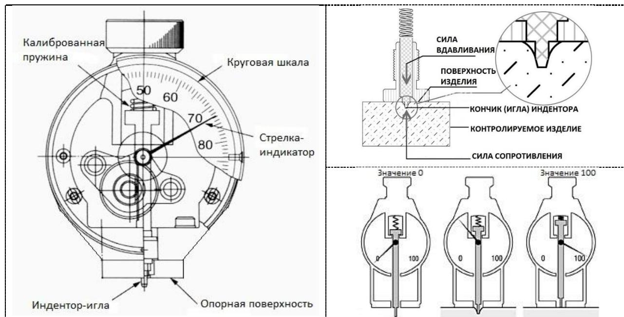
На получаемые результаты влияет форма индентора и прилагаемая к нему сила, поэтому между результатами, полученными при испытаниях с твердомером по шкале Шора тип А и твердомером по шкале Шора тип D, не может быть прямой зависимости.
