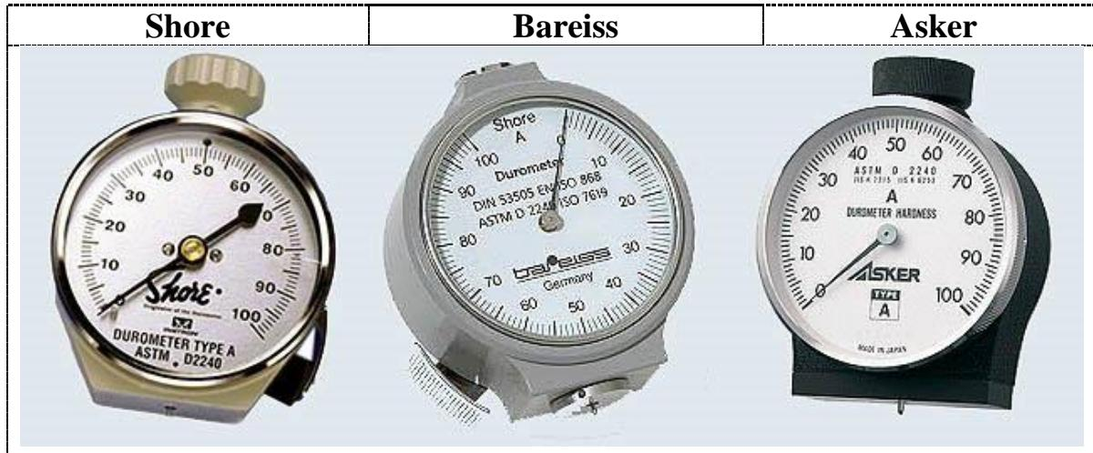
Шкалы твёрдости — первоначально дюрометры применялись для измерения твёрдости мягких резин, однако со временем возникла потребность измерять более твёрдые резины и пластмассы. А затем возникла потребность измерять ещё более мягкие резины, силикон и др. История развития шкал Шора следующая:
