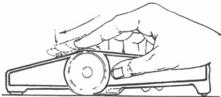
**Segundo:** Cuando el pivote del indicador visual se quede oprimido por si solo: Coloque su dedo índice sobre la rueda y gírela lentamente en dirección opuesta hasta que escuche un “clic” y el pivote “salte” de su posición.
