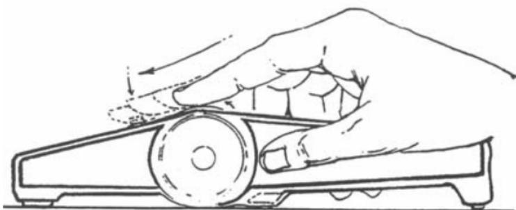
**Zweitens:** Sobald der Indikator unten bleibt: mit Ihrem Zeigefinger das Skalenrad langsam rückwärts drehen, bis Sie ein Klickgeräusch hören und der Indikator hochspringt.
