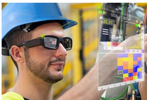
Мини ЭМА толщиномер EM4000 по Вашему желанию может быть дополнен **носимыми смарт-очками**. Носимые смарт-очки позволяют производить измерения ЭМА толщиномером EM4000 в труднодоступных местах, где считывание показаний прибора с дисплея не представляется возможным или затруднено. Показания в этом случае отображаются на стекле смарт-очков и их всегда видно оператору.
