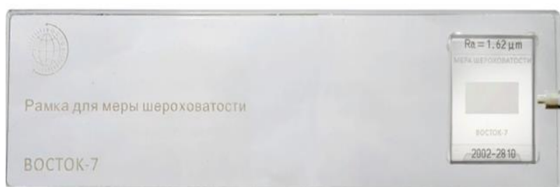
Рисунок 1 – Общий вид меры шероховатости поверхности в пластиковом прозрачном основании(а) и размещение меры в установочную рамку с выемкой и установка прибора для измерения шероховатости на рамке (б)
