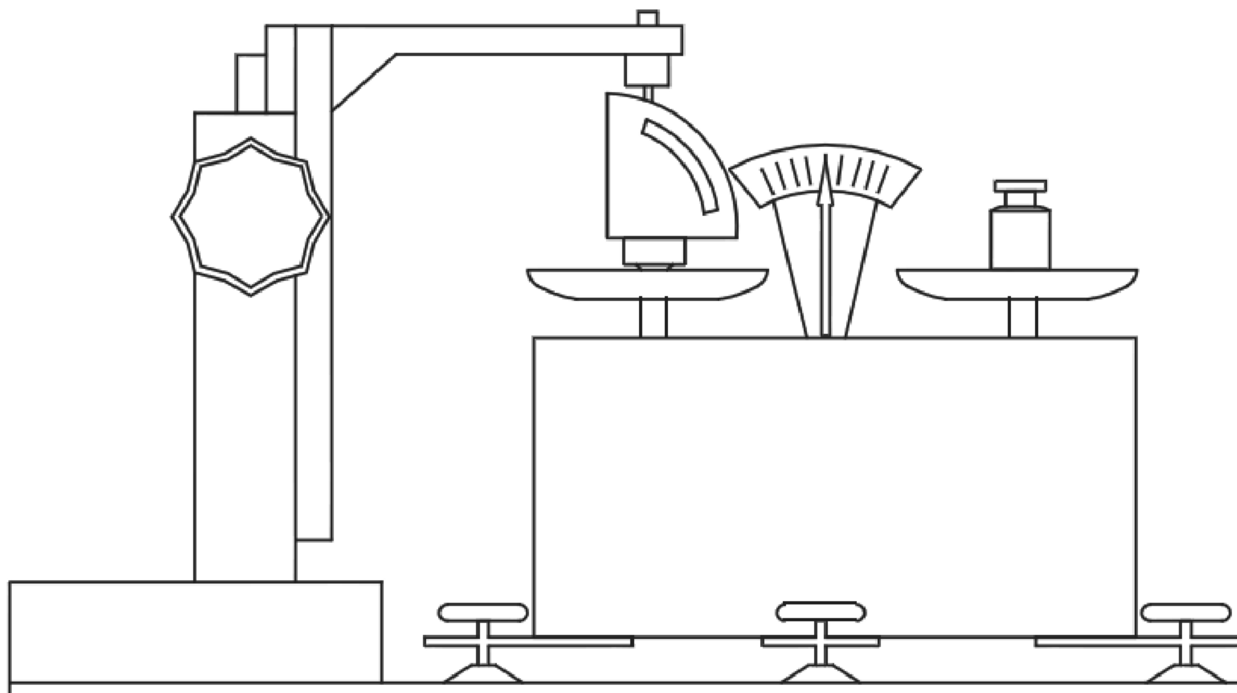
Рисунок 3 — Аппаратура для калибровки пружины дюрометра
