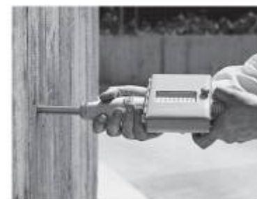
Рис. 2.2 Срабатывание ударного плунжера (1)
