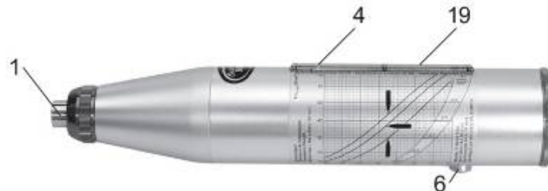
Рис. 2.4 Считывание результатов проведенного испытания по шкале (19) молотка
