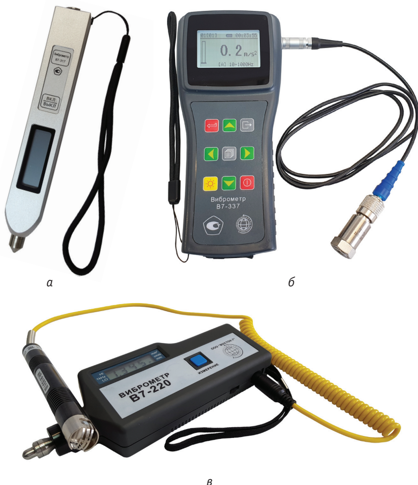
Рис. 1. Внешний вид виброметров линейки В7: а – В7-317 и В7-327; б – В7-337 с подключенным выносным датчиком; в – В7-220 с коротким щупом и подключенным датчиком температуры
