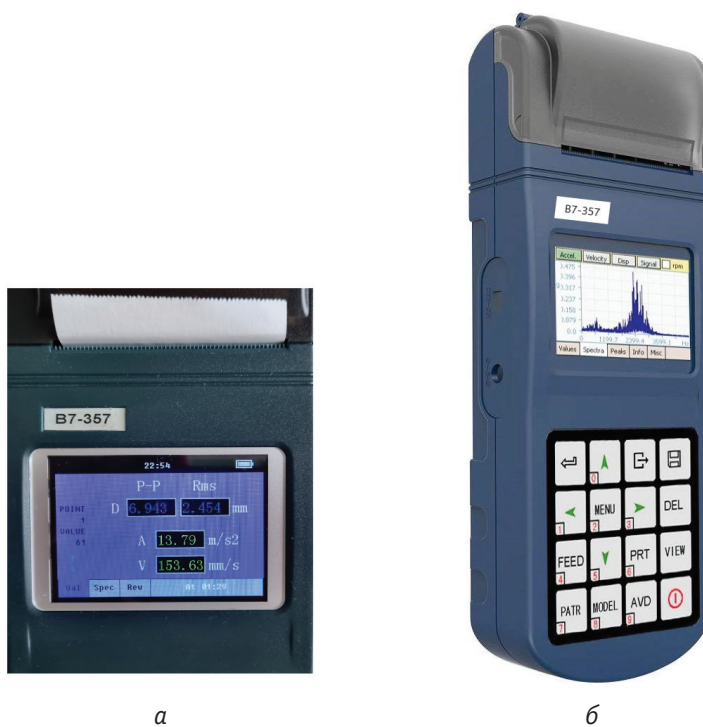
Рис. 2. Виброметр В7-357 с дисплеем и термопринтером: а – дисплей 3,5 дюйма и термопринтер крупным планом; б – общий вид прибора
