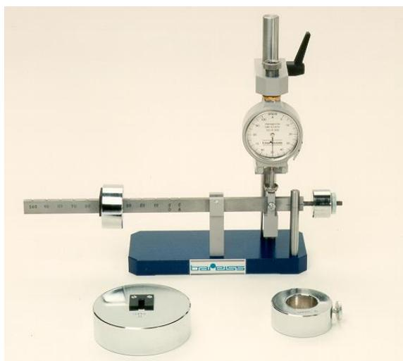
**Тестовый контрольный блок по SHORE A, D, B, C, DO, AO, O, OO, OOO, OOO S** с протоколом испытаний – для сверки точности показаний прибора
