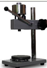
Штатив для твердомера ТВР-D компакт
