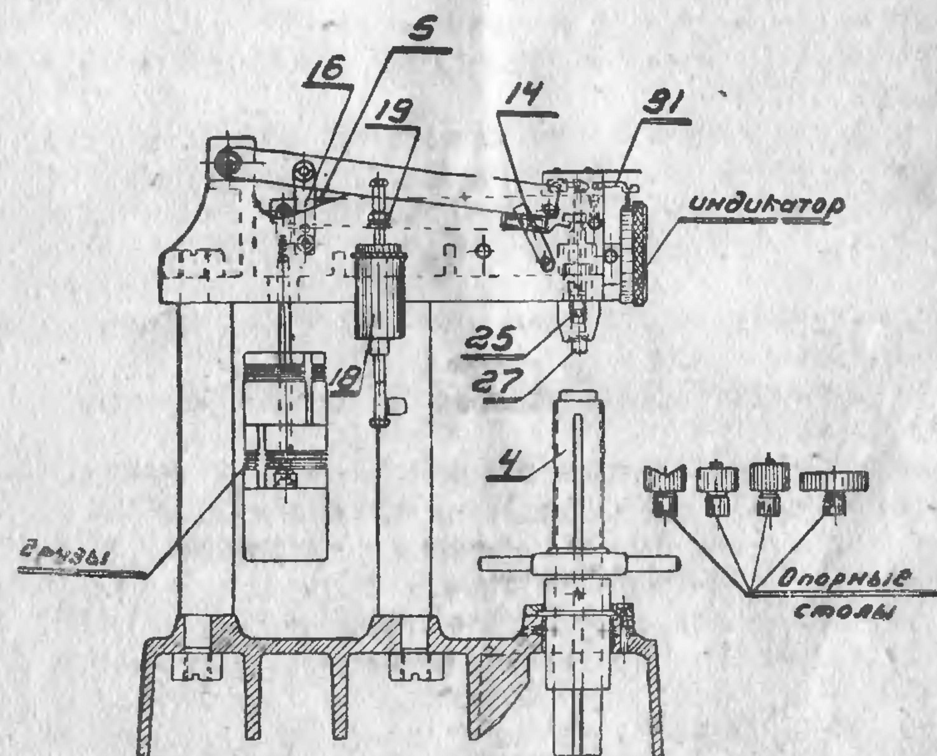
Кроме указанных основных частей, в состав прибора входит подъемный винт 4, на котором устанавливаются столы для испытуемых предметов, и амортизатор 18, служащий для постепенного наложения нагрузки.
