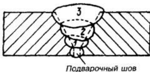
Рис. 7.16. Расположение слоев (валиков) при сварке стыков трубопроводов со стенкой толщиной 12 - 14 мм:
