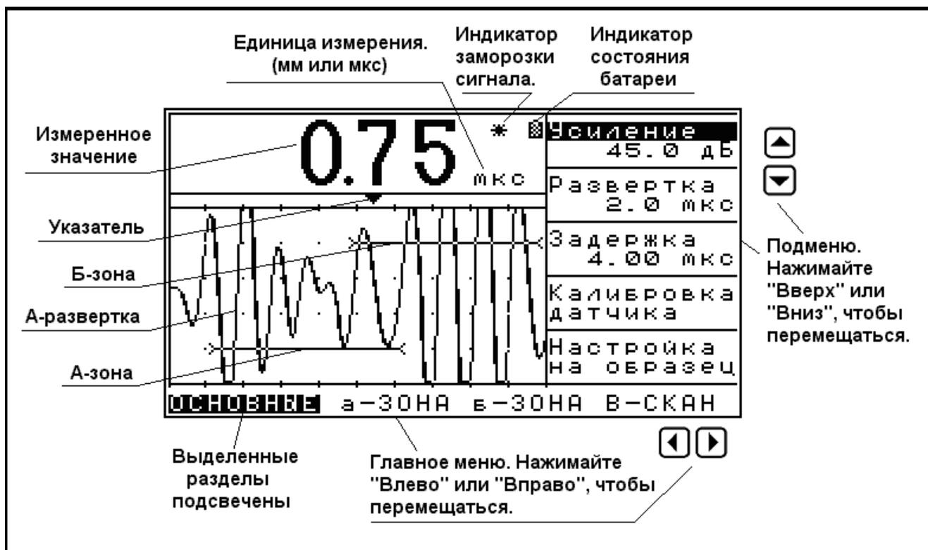
Рис. 2.10. Типичный вид экрана прибора в Режиме измерения.
