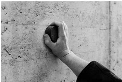
Используйте шлифовальный камень для шлифования тестовой поверхности. Выполните несколько тестовых ударов молотком для испытаний бетона на ровной твердой поверхности перед тем, как выполнять измерения, результаты которых планируется оценивать. Выполните проверку совпадения результатов с заданным диапазоном значений на тестовой наковальне.
