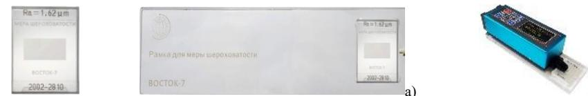
Рисунок 1 – Общий вид меры шероховатости поверхности в пластиковом прозрачном основании (а) и размещение меры в установочную рамку с выемкой и установка прибора для измерения шероховатости на рамке (б).
