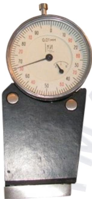
Твердомер для сухих форм и стержней модель 04421 предназначен для измерения поверхностей твердости сухих форм и стержней на формовочных и стержневых участках литейных цехов, в цеховых и заводских лабораториях формовочных материалов и в исследовательских организациях.
