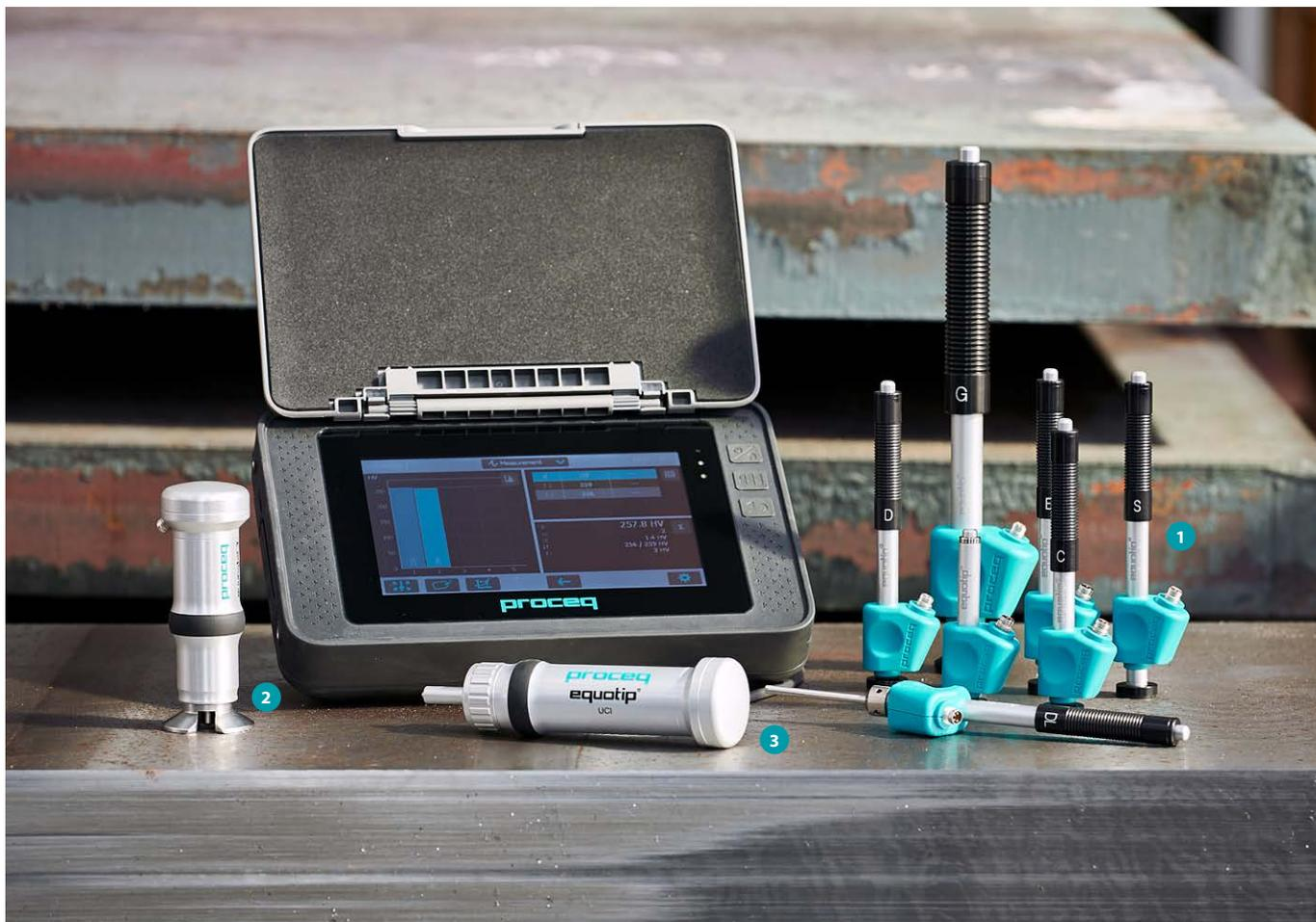
Equotip 550 с сенсорным экраном (слева направо): датчик Portable Rockwell, датчик UCI и датчику Leeb
