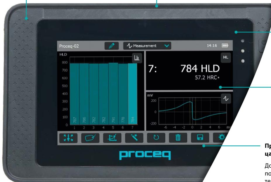
Сенсорный экран, используемый в твердомерах Equotip 550 и 540
