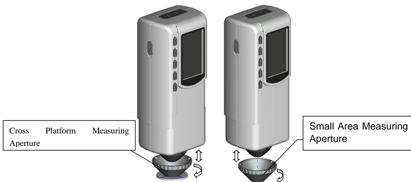
Рисунок 5 Установка и снятие измерительной апертуры
