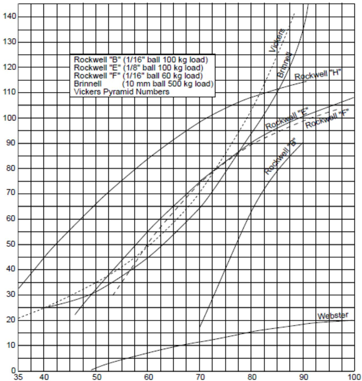
**Примерная таблица перевода значений твёрдости для модели GYZJ-934-1 в шкалы твёрдости Роквелла, Бринелля и Виккерса**
