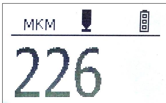
Рис. 2-2 Результат калибровки на образце 226 мкм
