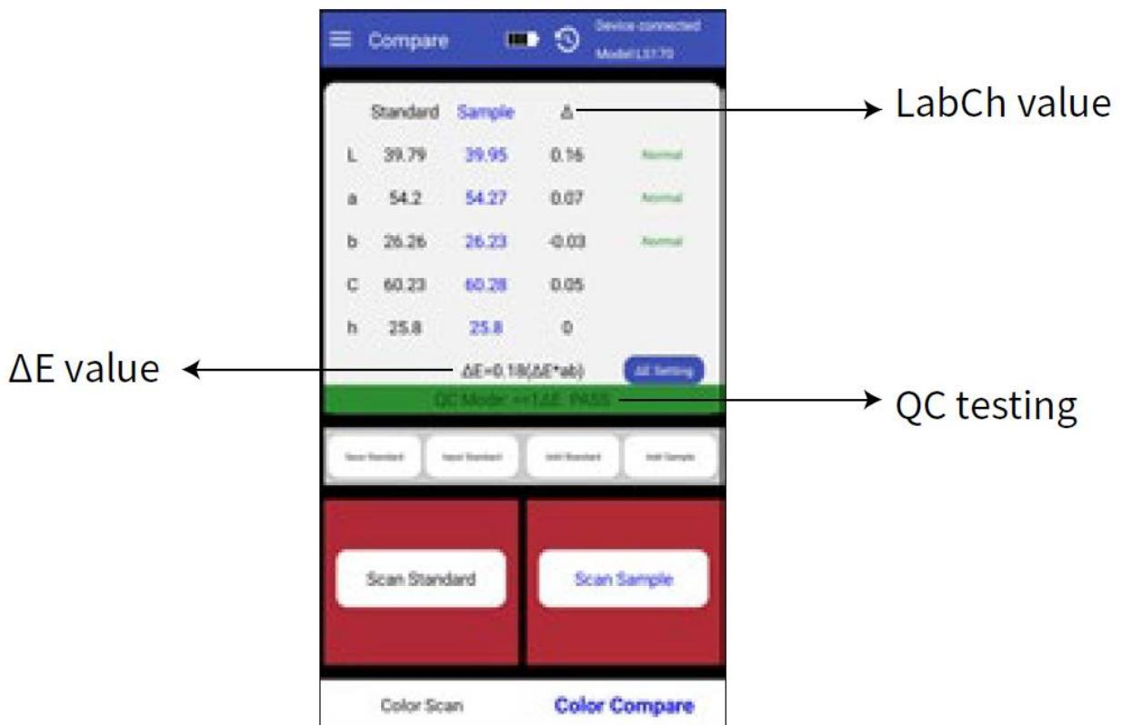
После измерения или добавления стандартного цвета и измерения или добавления образца цвета измерение сравнения завершено (запись сравнения сохраняется автоматически). Вычисление цветового различия выполняется для двух цветов. Результаты сравнения цветовых различий обычно имеют следующие три суждения:
