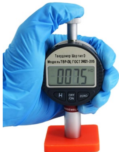
ТВР-D твердомер (дюрометр) Шора тип D Артикул ТВР-D № для заказа 002213
