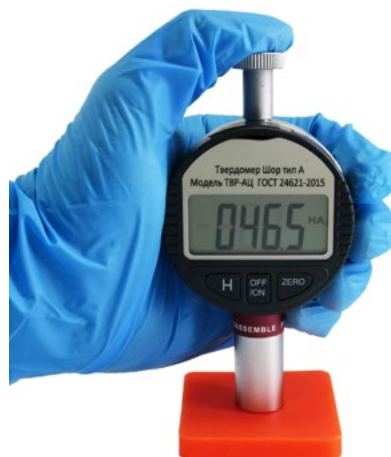
ТВР-А твердомер (дюрометр) Шора тип А Артикул ТВР-А № для заказа 002212
