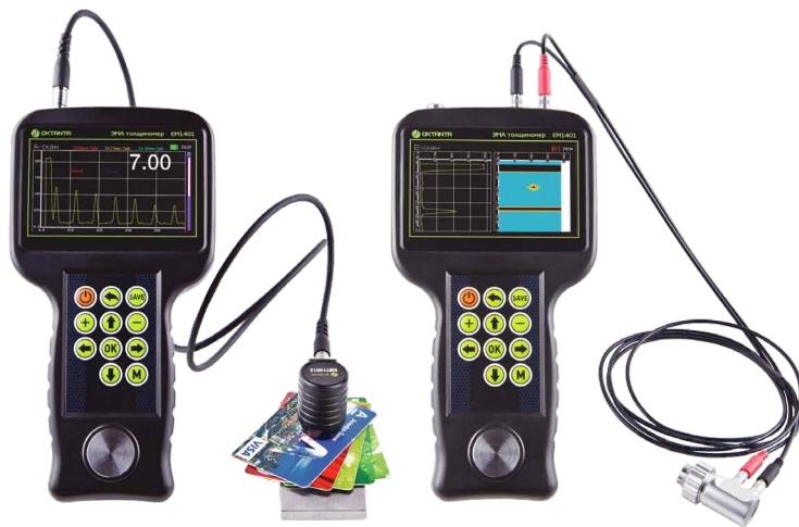
EM1401 (UT) легко и быстро калибруется по известной толщине или скорости звука, а также по типу измеряемого металла. Наличие режима работы со стробами позволяет использовать данный прибор в качестве дефектоскопа с прямым вводом. Высокая скорость работы прибора (16 измерения в секунду) позволяют Вам легко и быстро проводить измерения толщины на протяжённых объектах контроля.
